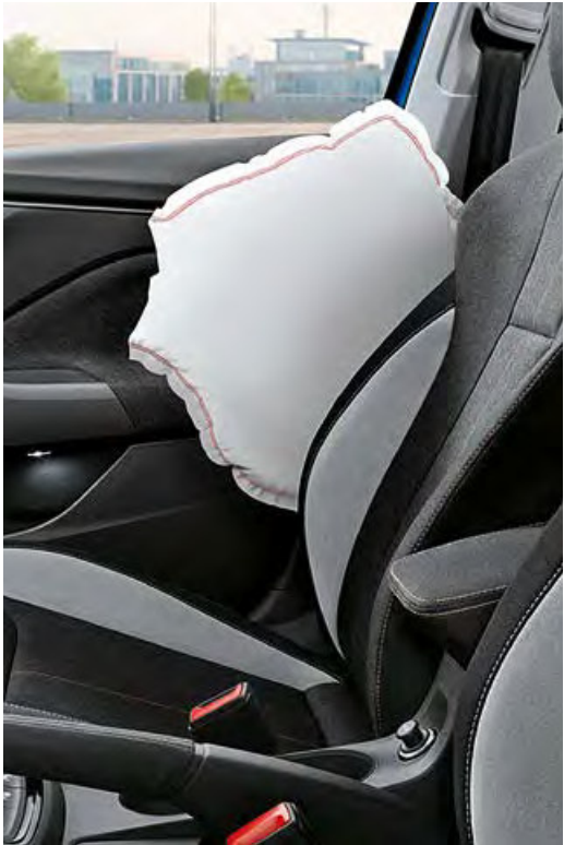
SEITENAIRBAGS VORN UND HINTEN Diese vier Airbags dienen als Schutz für Becken und Brustkorb von Fahrer und Mitfahrern bei einem seitlichen Aufprall (hintere Seitenairbags optional).
