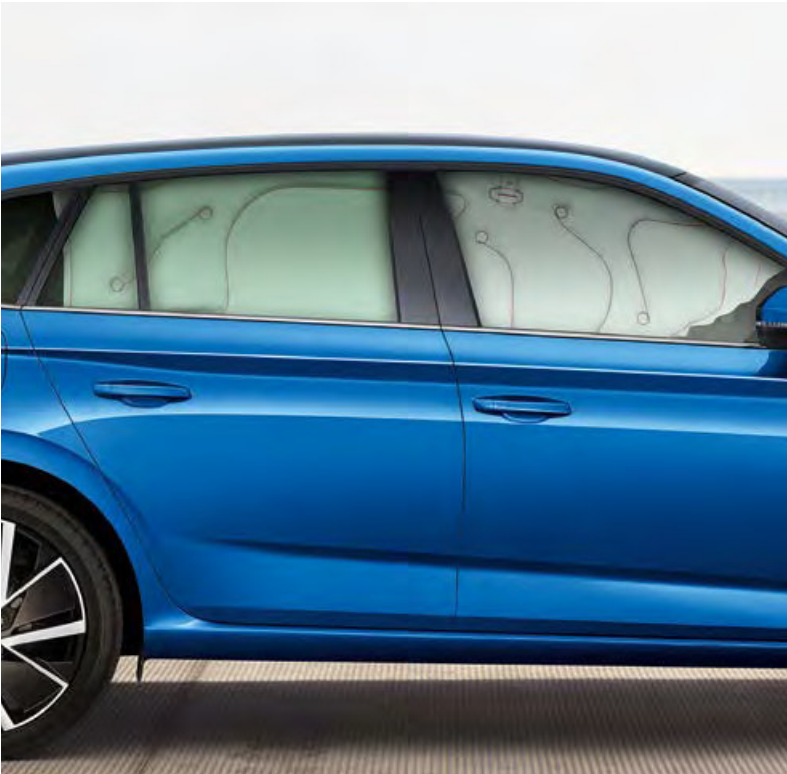
KOPFAIRBAGS Aktivierte Kopfairbags bilden einen Puffer, der sowohl die vorderen Passagiere als auch die Fahrgäste im Fond vor Kopfverletzungen schützt.
