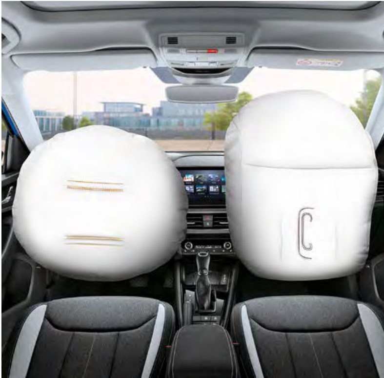
FAHRER- UND BEIFAHRERAIRBAGS Der Fahrerairbag ist im Lenkrad untergebracht. Der Airbag für den Beifahrer befindet sich in der Armaturentafel und kann bei Bedarf abgeschaltet werden, wenn ein Kindersitz angebracht werden soll.
